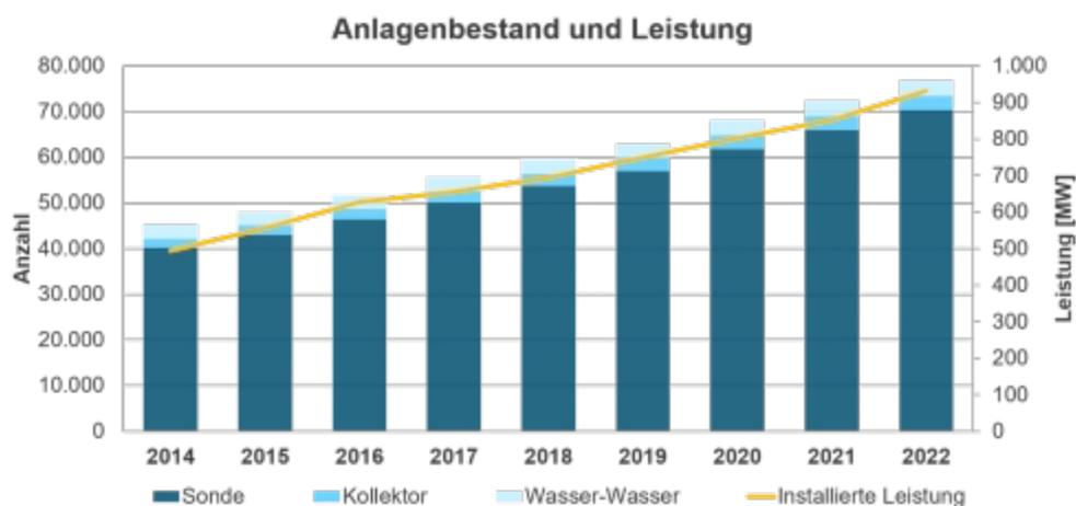
Abbildung 1: Anzahl und Leistung erdgebundener Wärmepumpen von 2014 - 2022 nach Anlagenart
